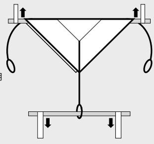
\*上図のような試験を行いました。計算上は上記の数値の2倍の強さが実証されます。ただし、吊荷が各ベルトに平均に加重されることが条件になります。
