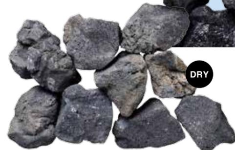
・重量制限や作業効率に最も適した素材として注目されている火山岩(スコリア)。加工性の良さと多孔質の特徴である保水排水効果でなおかつ天然石軽石や溶岩とは違う中性的なマテリアルです。
