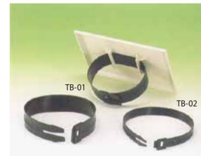
針金などで樹木用名板を結束するいままでの方式では、針金が樹木に食い込み、その成長をさまたげる恐れがありました。トゥリーベルトは樹木の幹の成長とともに自然に広がって、幹の表面を傷付けません。取り付けも簡単で、また、幹の太さに合わせて何本でもつなげることが出来、しかもベルトには浮き出し目盛りがついているので、樹木の成長が一目で分かります。成長測定のためにベルト単体のみを使用することもでき、樹木生産業や営林署管轄などにとっても理想的なベルトといえます。台風対策としてφ2mmの穴を開けてあり、樹木に固定することもできます。管理樹木用の大木にも取付可能な、トゥリーベルト特注サイズも承ります。
