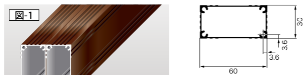
アルミ支柱サンロク角を2本合わせた断面
