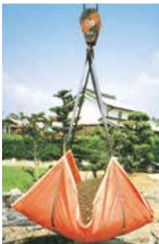
上の写真は、エイコーモッコタスキB マスク型(7尺)に約1.3tを吊したものです。
