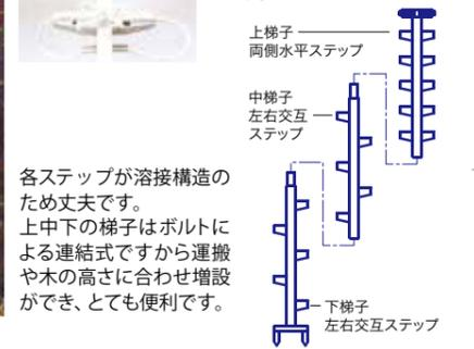
各ステップが溶接構造のため丈夫です。上中下の梯子はボルトによる連結式ですから運搬や木の高さに合わせ増設ができ、とても便利です。
