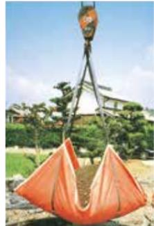
上の写真は、エコモッコタスキBマスク型(7尺)に約1.3tを吊したものです。
