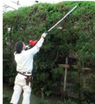
手にしっかりフィットするグリップにより首振り上下最大30°幅の角度変更でも安定した切断作業が可能です。シャトルとウエイトを逆方向に駆動させるカウンターウエイト方式の採用で、振動による腕への負担を和らげます。
