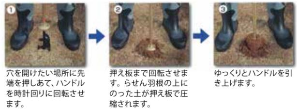
1 穴を開けたい場所に先端を押しあて、ハンドルを時計回りに回転させます。
