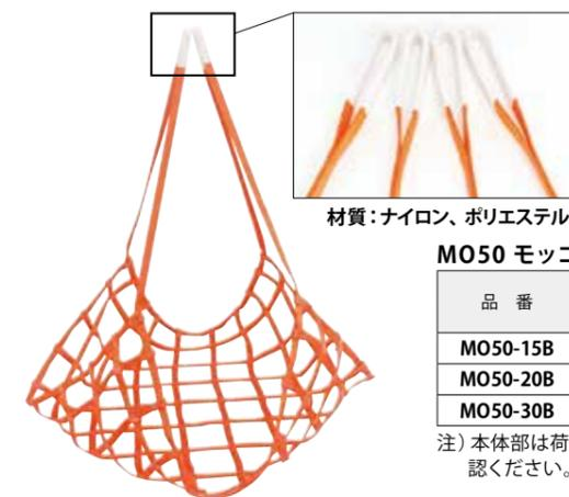
不定形な荷や崩れやすい荷専用の特許型ベルトスリングです。合成繊維製なので軽量で強く、吊り荷にやさしい製品です。ワイヤーモッコのように錆びず、摩擦によるトゲの発生や折り曲げによるキンクの心配もありません。
