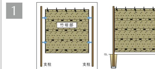
まず組立済竹垣の両側のアルミチャンネルハネ部分のセンターV溝にビスで両支柱に取り付けます。(組立済両柱使用竹垣完成) 最初のスパンは両柱付の竹垣を埋め込み固定します。
