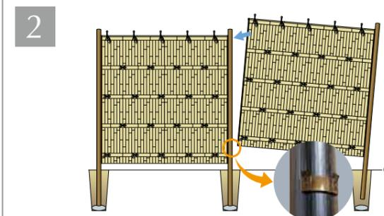
組立済竹垣の片側のアルミチャンネルハネ部分のセンターV溝にビスで片支柱に取り付けます。(組立済片柱使用竹垣完成) 埋め込み固定された柱の、竹垣の下部を受ける所にチャンネルハネ付受け金具を取り付けます。※両柱付、片柱付の組立済竹垣をご購入の場合は2~4をくり返してください。
