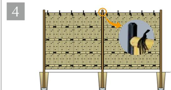
固定された丸柱とチャンネルハネ付丸柱用のハネ部分のセンターV溝にビス止めし、柱を固定してください。※連続する場合は2~4をくり返します。使用ビスはP.133の対応ビスを参照ください。サラビス小頭使用の場合はD=6用サラ割りをしてからビス止めしてください。弊社にて竹垣を製作する場合はサラ割りサラビス小頭付で製作させていただきます。
