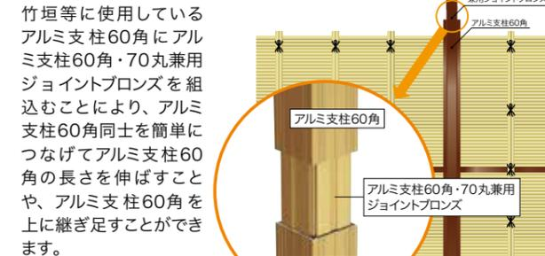
竹垣等に使用しているアルミ支柱60角にアルミ支柱60角・70丸兼用ジョイントブロンズを組み込むことにより、アルミ支柱60角同士を簡単につなげてアルミ支柱60角の長さ伸ばすことや、アルミ支柱60角を上へ継ぎ足すことができます。
