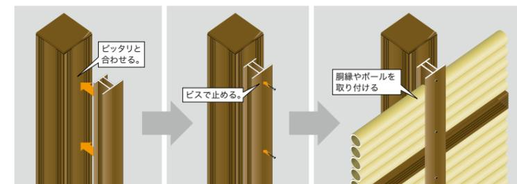
角型アルミ支柱(80角・八角・60角・40角・サンロク角)にアルミH型フレーム22をピッタリと合わせる。
