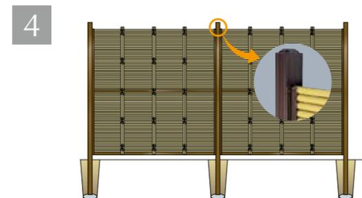
固定された柱とチャンネルハネ付のハネ部分のセンターV溝にビス止めし、柱を固定してください。※連続する場合は2~4をくり返します。使用ビスはP.133の対応ビスを参照ください。サラビス小頭使用の場合はD=6用サラ割りをしてからビス止めしてください。弊社にて竹垣を製作する場合はサラ割りサラビス小頭付で製作させていただきます。
