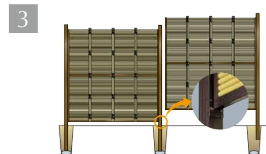
取り付けしたチャンネルハネ付受け金具に片柱使用の組立済竹垣のチャンネルハネ付を乗せ、固定させた柱にピッタリと添わせませす。
