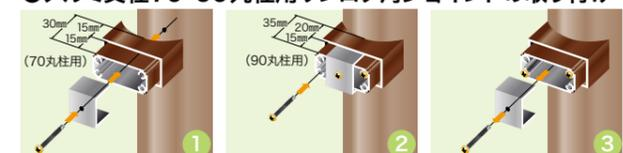
柱に予め下穴を開けてから、ジョイントに治具を被せ、付属のビスで固定する。下穴は必ず開けておいてください。ただし、ドリルを強く押さえつけると位置がずれることがあります。
