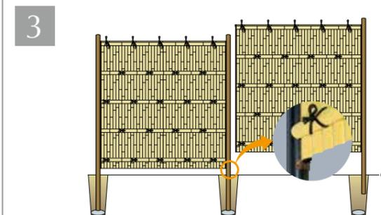
取り付けしたチャンネルハネ付受け金具丸柱用に片柱使用の組立済竹垣のチャンネルハネ付丸柱用を乗せ、固定させた丸柱にピッタリと添わせませす。
