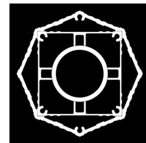
3層補強システム使用時の断面
