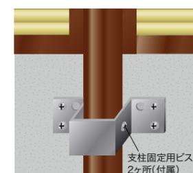
●アルミ支柱に壁面ブラケットを被せ、ビスで壁面にしっかりと固定します。壁面がコンクリートの場合はビスピタ、重量物用アンカー6φ等を、ブロックの場合は偏芯プラグ、コンクリートプラグF-6セット等を使用して下さい。(P.126・P.175参照)
