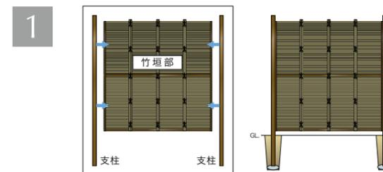
まず組立済竹垣の両側のアルミチャンネルハネ部分の耳をセンターV溝にビスで両支柱に取り付けます。(組立済両柱使用竹垣完成) 最初のスパンは両柱付の竹垣を埋め込み固定します。
