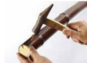
▲しかしながら、背割加工のみでは乾燥によりその部分の開いてくる恐れがあるので、開きを防止するため竹の釘を一定間隔で固定します。
