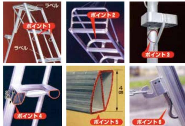
**ポイント1** 新しくロープフックが付きました。三脚の上段(全高180cm以下のAP・AMPは天板を含め上から2段目段目210cm以上は上から2段目、3段目)で作業する場合や、天板をまたいで補助ステップに乗る時はこのロープフックを利用し、脚立を頑丈な立木などと丈夫なロープで固定してください。
