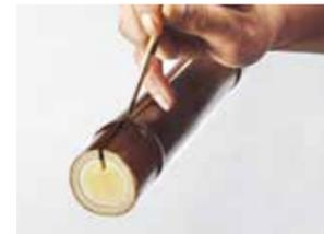
仕上げに、背割部分を同色でタッチアップによりその部分の開いてくる恐れがあるため、開きを防止するため竹の釘を一定間隔で固定します。以上の加工をすることにより、施工後の割れのリスクを無くすように工夫しています。
